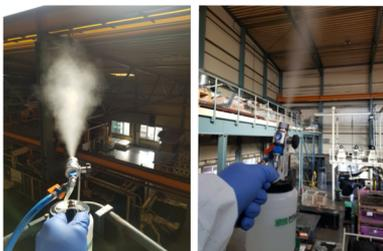
Aus BiOxi (flüssiger Wirkstoff) wird Trockennebel erzeugt. Trockennebel ist ein Aerosol, dessen Partikel kleiner als 10 µm sind (auch Ultra-Fine Atomization genannt).
